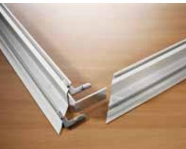
Die acht Eckwinkel werden zunchst in zwei gleichlange Rahmenprofile (jeweils zwei) seitlich in die dafr vorgesehenen Profilkammern eingeschoben. Ebenso werden die weiteren Profileile auf die Winkelverbindung aufgeschoben.
