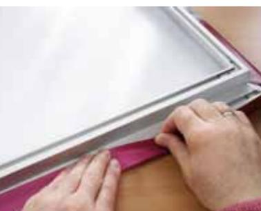
Der Aufsichtsträger wird an allen vier Ecken fixiert. Die weitere Verspannung erfolgt an den Längs- und Querseiten, immer gegenüberliegend abwechselnd zu den Ecken. Zwischendurch ist immer darauf zu achten, dass alle vier Ecken ihre Passgenauigkeit beibehalten.
