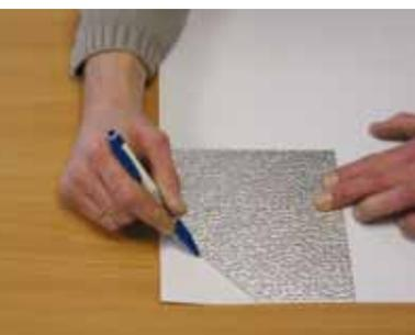
Das Aufsichtsmotiv muss umlaufend 40 mm größer als das Außenmaß des Roma „35“ Rahmens sein. Alle vier Ecken des Aufsichtsträgers werden mittels Eckschablone angezeichnet und ausgeschnitten. Die Eckschablone dient als Anhaltspunkt und liefert nicht für alle Materialien eine verbindliche Passgenauigkeit.
