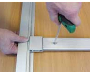
Beim Roma „35“ Rahmen ber 2,5 Meter Lnge wird die mitgelieferte Sttzstrebe zentriert eingesetzt. Die Sttzstrebe wird mittels eines Torxschlssels T30 mit Spannschlssern in dem Rahmen fixiert.
