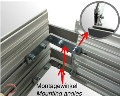
Die acht Eckwinkel werden zunächst in die Rahmenprofile (jeweils zwei pro Ecke) in die dafür vorgesehenen Profilkammern eingeschoben. Achten Sie darauf, dass die richtigen Ecken zusammengesetzt werden (A/A; B/B; C/C; D/D) Ebenso werden die weiteren Profilverteile auf die Montagewinkel aufgeschoben.
